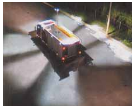
Xenon reflektori imaju ukupnu snagu od samo 245 W. Svjetlosna jakost je za činitelj 20 viša, nego kod uobičajenih stupova s četiri reflektora
